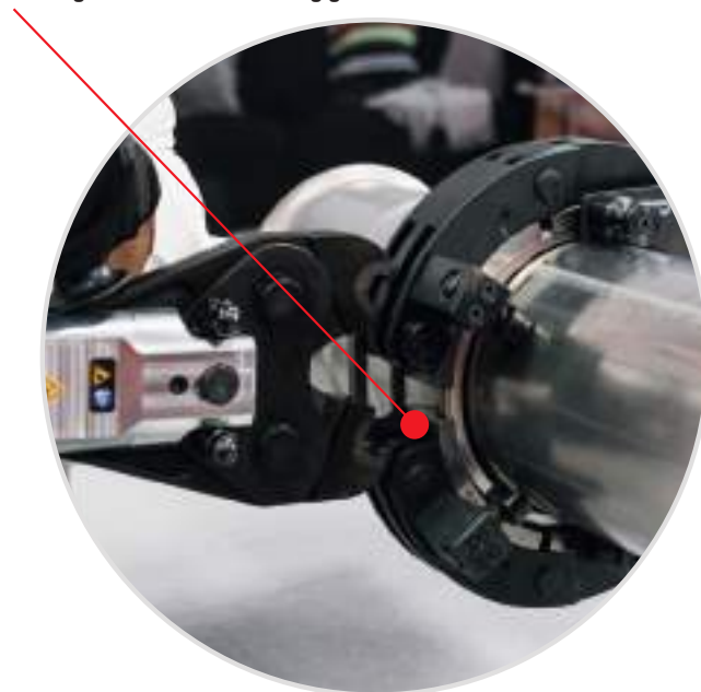
Scanalatura della catena sopra la sede di contenimento dell'o-ring Chain groove above the o-ring groove
